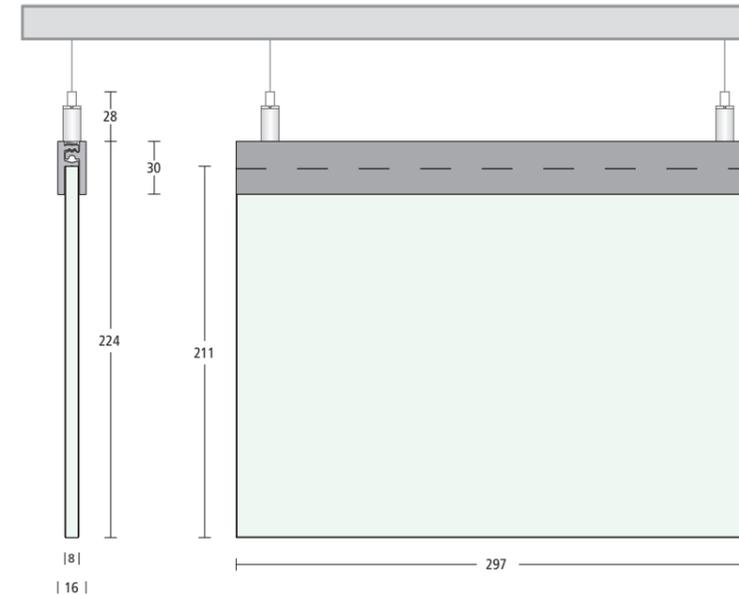
Deckenabgehängte Wegweiser im System **transparenz** bieten den besonderen Reiz einer wertigen Informationsübermittlung. Auch wenn diese durch die transparente Fläche leicht wirken, muss die Belastbarkeit einer abgehängten Decke mit dem Gewicht der Scheiben bedacht werden. Deckenschilder, die beidseitig gesehen werden, erfordern eine Hinterdeckung, um Spiegelschrift zu vermeiden.
