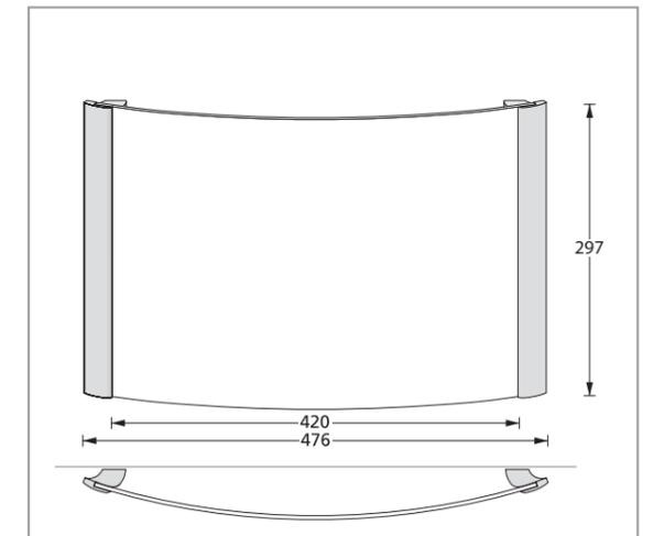
Die Größe der wandmontierten Wegweiser 3042 entsprechen der Größe DIN A3 quer. Das Achsmaß ist wichtig für die Montage der Profile an der Wand, es gibt den Abstand der Wandbohrungen zueinander an. Das Achsmaß für Wegweiser im 540er Modulraster beträgt 522 mm. Artikelnummer mit lackierten Profilen: SWO 3042 L
