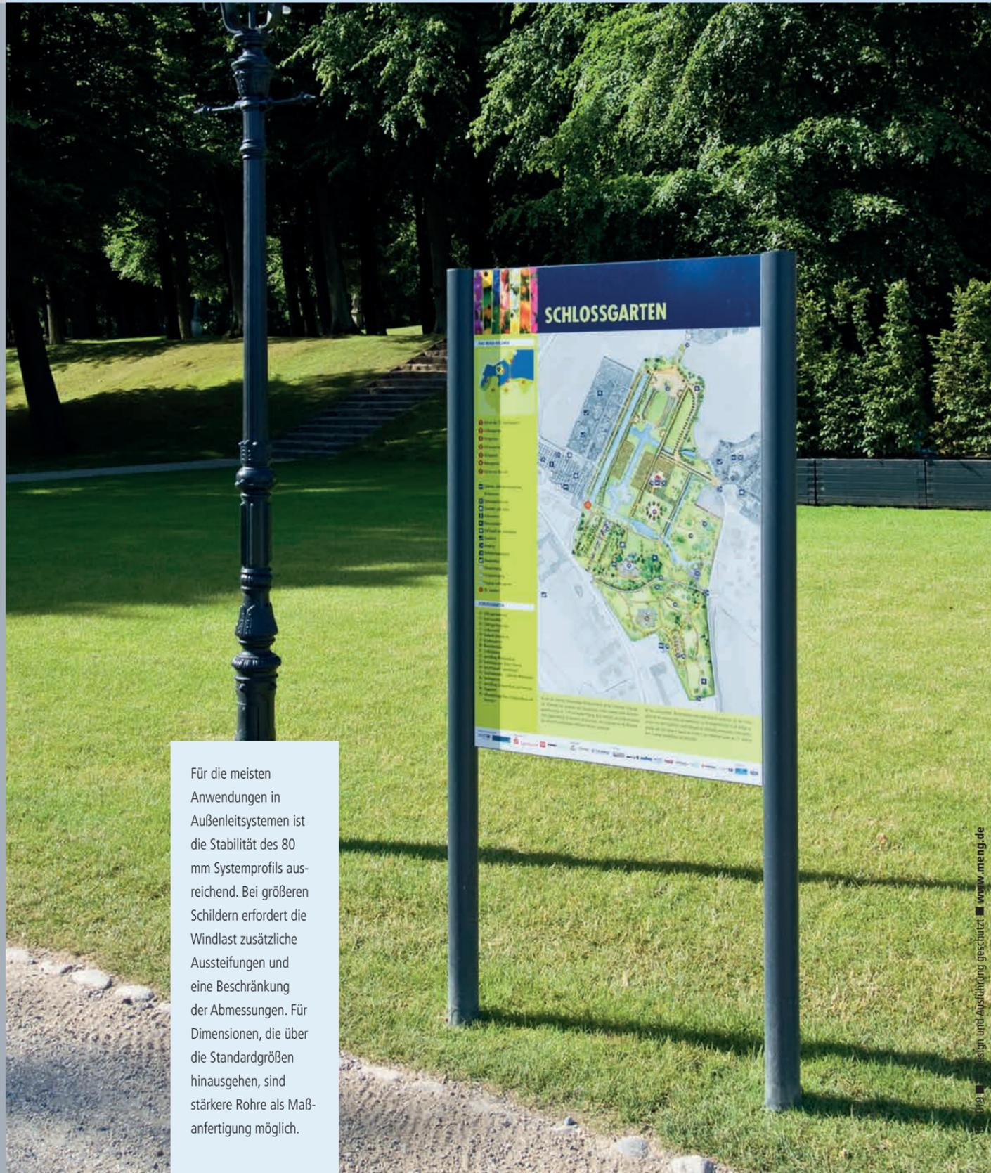
Für die meisten Anwendungen in Außenleitsystemen ist die Stabilität des 80 mm Systemprofils ausreichend. Bei größeren Schildern erfordert die Windlast zusätzliche Aussteifungen und eine Beschränkung der Abmessungen. Für Dimensionen, die über die Standardgrößen hinausgehen, sind stärkere Rohre als Maßanfertigung möglich.
