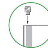
Gegen unbefugte Entnahme sind die Einlagen oben mit 2 Stiftschrauben gesichert. Nie fest andrehen!
